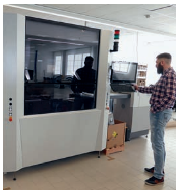
Das neue Lasersystem PaperOne 3500 von SEI Deutschland bei Abel kommt bei der digitalen Fertigung von Faltschachteln und Etiketten zum Einsatz. David Abel zeigt Muster, die vollautomatisch damit produziert wurden.
